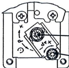
**Druckeinstellung / Pressure setting / Ajuste de presión / Réglage de la pression / Regolazione della pressione**
