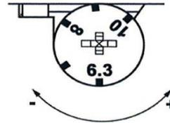
Motorenstrom am Excenter des SK-R3 Überstromrelais wie abgebildet einstellen.
